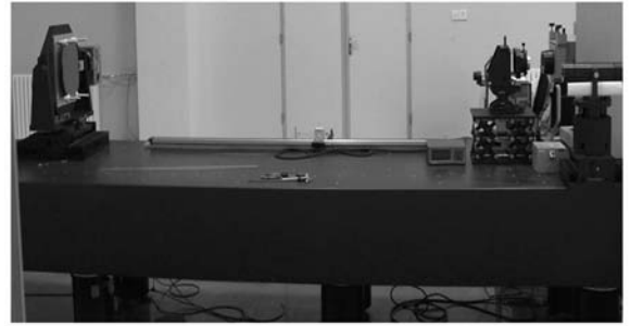
(a) 使用 CGH 检测离轴非球面
